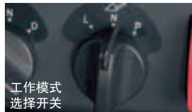
工作模式选择开关 P模式：重载挖掘 N模式：装载 L模式：轻载荷作业
